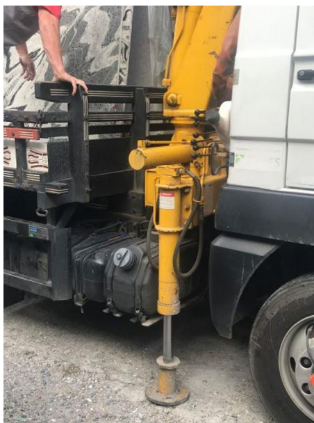
Figura 20 - Apoio para equilíbrio do caminhão munck
