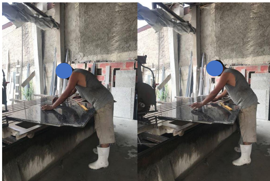
Figura 22 - Funcionário realizando marcações na peça para receber o corte
